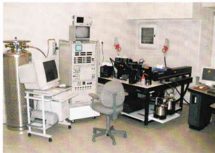
Ryc. 1. Cytometr przepływowy MoFloSX (DakoCytomation, USA) przeznaczony do seksowania nasienia ssaków
