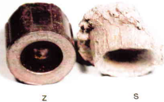
Ryc. 6. Breneka w swoim naturalnym kształcie (z) i zdeformowana po uderzeniu (s)
