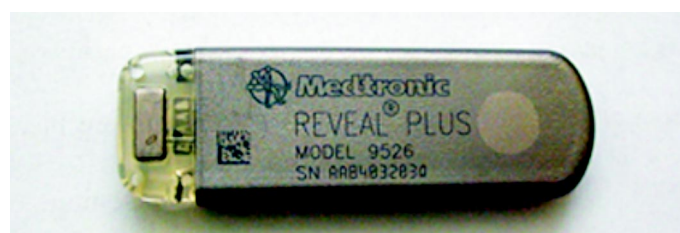
Ryc. 1. Rejestrator pętlowy Reveal Plus firmy Medtronic
