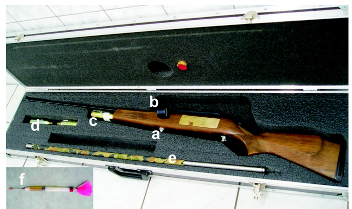
Ryc. 3. Karabin Palmera. Widoczne na zdjęciu elementy: a) manometr służący do regulacji siły wyrzutu strzykawki; b) wskaźnik pokazujący ciśnienie regulowane przy pomocy manometru; c) pojemnik zawierający sprężony CO 2 , którego siła rozprężania służy do wystrzeliwania strzykawki; d) zapasowe pojemniki zawierające CO 2 ; e) zamienna lufa o większej średnicy przeznaczona do strzykawek o większej objętości; f) gotowa do wystrzelenia strzykawka zawierająca lek. Foto: Mirosław Kalicki
