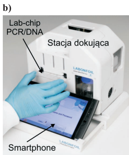
Ryc. 2. Miniaturowe instrumenty do detekcji materiału genetycznego metodą real-time PCR z wykorzystaniem lab-chipów PCR/DNA: a) opracowanie wykorzystywane do detekcji patogenów żywności, czas namnażania poniżej 20 minut (48), b) system (lab-chip w formie jednorazowej karty diagnostycznej, stacja dokująca oraz smartfon z oprogramowaniem) do detekcji patogenów żywności, ochrony środowiska i wspomaganie terapii onkologicznej z on-chip oczyszczaniem, przygotowaniem do namnażania i namnażaniem próbki w lab-chipie; całkowity czas analizy typu sample in answer out wynosi poniżej 60 minut ( www.labonfoil.eu )
