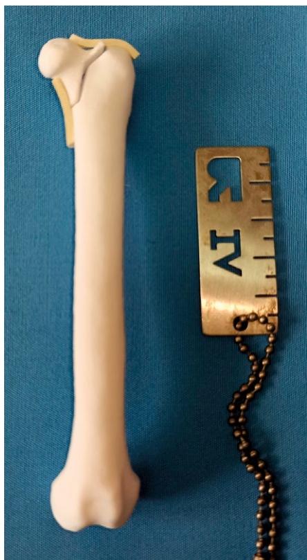
Ryc. 5. Model prawej kości udowej kota ze złamaniem 3B1-1 po odcięciu podpór i wypiskowaniu
