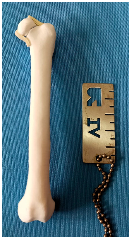
Ryc. 6. Model prawej kości udowej kota ze złamaniem 3B1-2 po odcięciu podpór i wypiskowaniu
