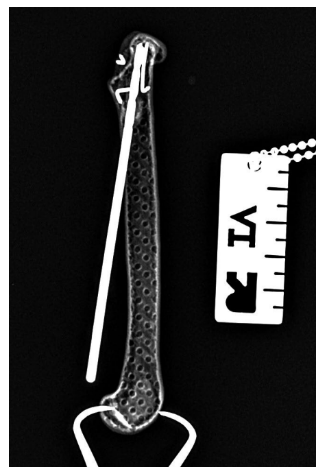
Ryc. 4 b. Radiogram prototypowego modelu prawej kości udowej kota w projekcji profilowej bocznej, wykonany po wywierceniu otworu w szyjce kości udowej (widoczny kratownicowy typ wypełnienia druku)
