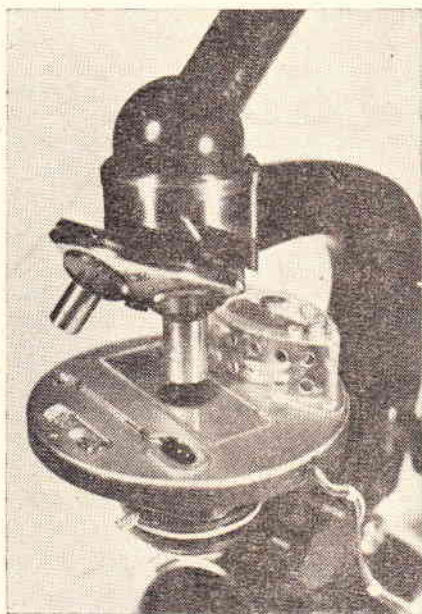
Fot. 2. Mikrotermostat „WW-1”. Płytką ogrzewającą ustawioną na stoliku mikroskopu
