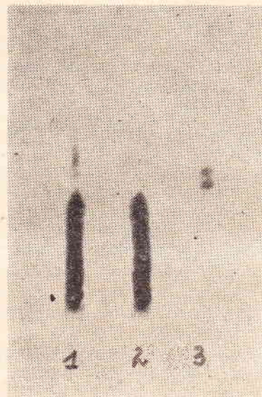
Ryc. 1. Chromatogram cienkowarstwowy na żelu krzemionkowym wywołany odczynnikiem cerowym. 1. — miód+sól cholinowa N-glukozylopolifunginy (10 j/g), 2. — miód badany, 3. sól cholinowa N-glukozylopolifunginy (4 j/ml)
