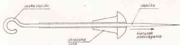
Ryc. 1. Schemat przedstawiający sposób użycia skróconej igły do wyprostowania oczka szpilki
