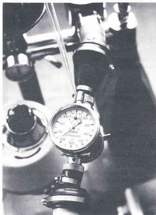
Ryc. 1. Volumetr Drägera z poszerzonymi króćcami wlotowym i wylotowym, umożliwiającymi okresowe podłączenie do układu anestetycznego i dokonywanie pomiarów
