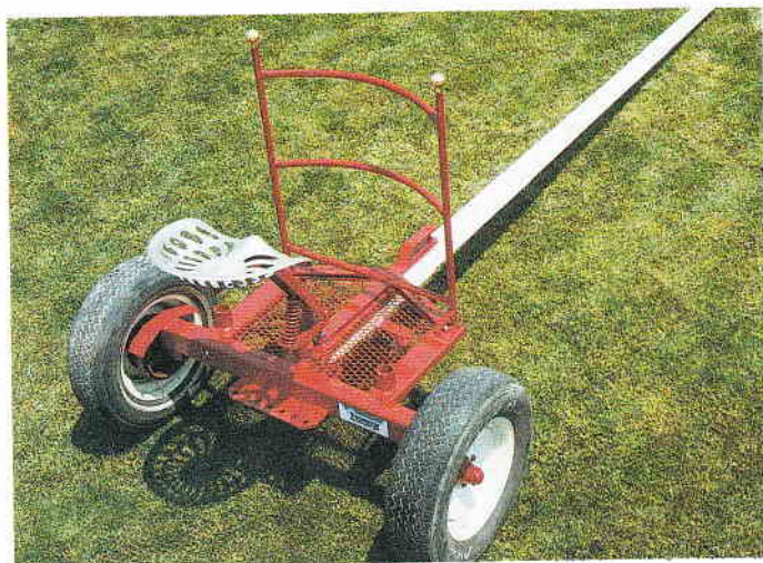
Ryc. 3. Zwykły konny przodek roboczy, f-my Pioneer Equipment inc., USA
