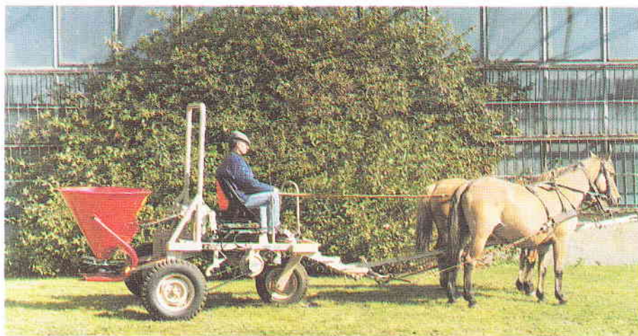
Ryc. 5. Trójkołowy, 3-punktowy, konny przodek roboczy „Teamster 2000” o napędzie od kół jezdnych wałka odbioru mocy oraz akumulatorem układzie hydraulicznym, f-my Journeys End International, inc. USA, z zawieszonym traktorowym rozsiewaczem nawozów. Fot. Emil Sasimowski
