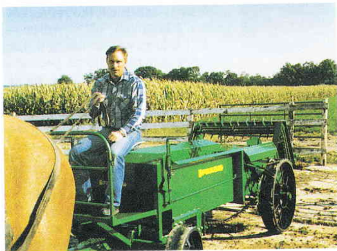
Ryc. 1. Konny roztrzaskacz obornika z napędem od kół jezdnych, f-my Pequea Machine, inc., USA
