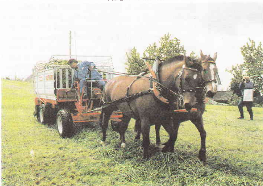
Ryc. 6. Czterokołowe, konne podwozie robocze z silnikiem napędzającym nałożony wymienny sprzęt: przyczepa samobierająca – na zdjęciu, roztrzásacz obornika, rozlewacz gnojowicy, wywrotka i in. f-my Hässig, Szwajcaria
