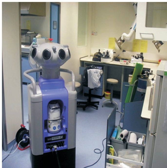
Ryc. 4. Rozmieszczenie generatora Bioquell Z w pomieszczeniu
